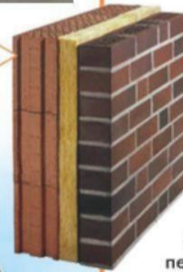
Между утеплителем и облицовочным кирпичом оставлен воздушный зазор
