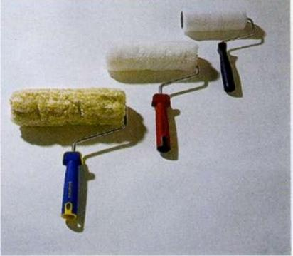
▶ В зависимости от типа грунтовки и краски подбирают ворс малярного валика. Длинный ворс – для шершавой поверхности, средний – для гладкой стены, короткий – для деликатного финишного окрашивания
