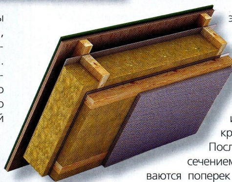
Укладка тепло- и пароизоляции в конструкцию из стальных профилей Lindab
