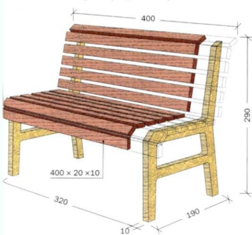
▼ Схема изготовления декоративной скамеечки (размеры даны в мм)
